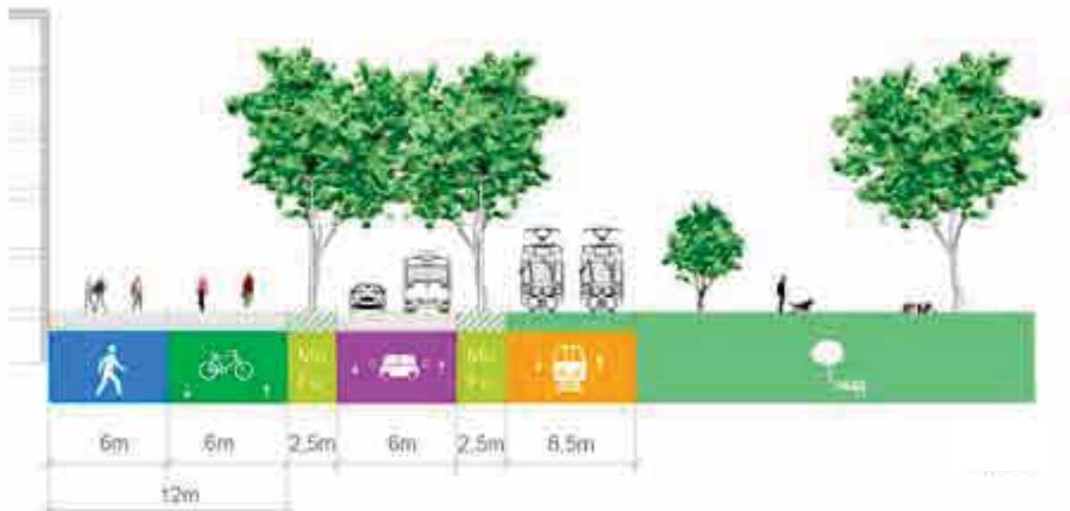
Regelquerschnitt im westlichen Teil der Ringstraße | Parkway (mit Strassenbahntrasse; Blickrichtung Norden)
